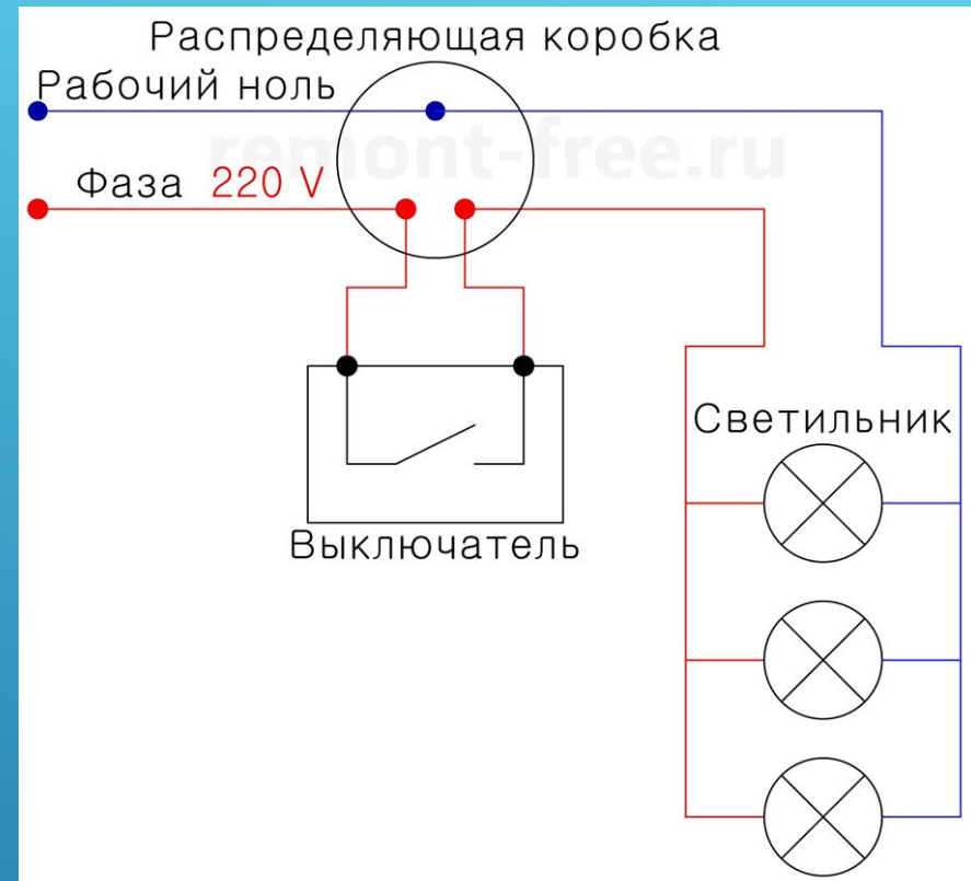
Параллельное соединение светильников
