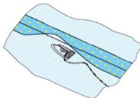
Рис. 5.14. Проутюживание участков под припусками швов
