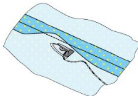
Рис. 5.14. Проутюживание участков под припусками швов
