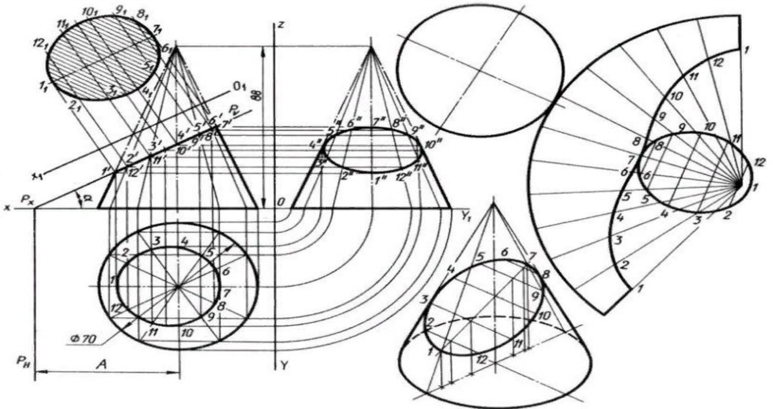
Построить три проекции конуса, усеченного плоскостью Р, натуральную величину сечения, развертку и изометрию
