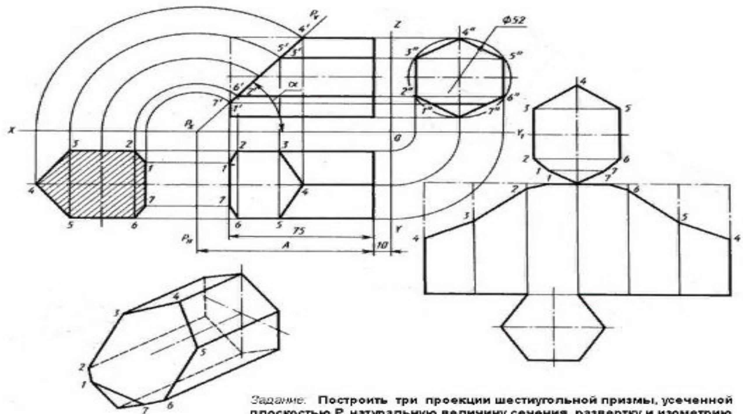
Задание. Построить три проекции шестиугольной призмы, усеченной плоскостью Р, натуральную величину сечения, развертку и изометрию
