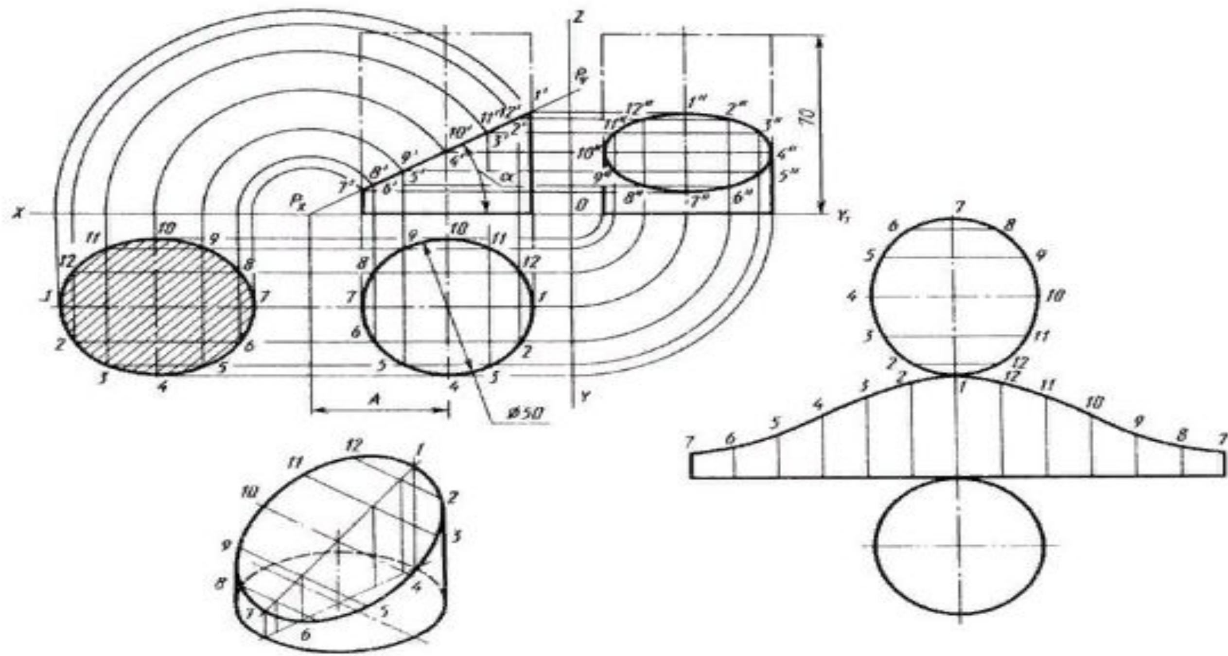
Построить три проекции цилиндра, усеченного плоскостью  $P$ , натуральную величину сечения, развертку и изометрию.
