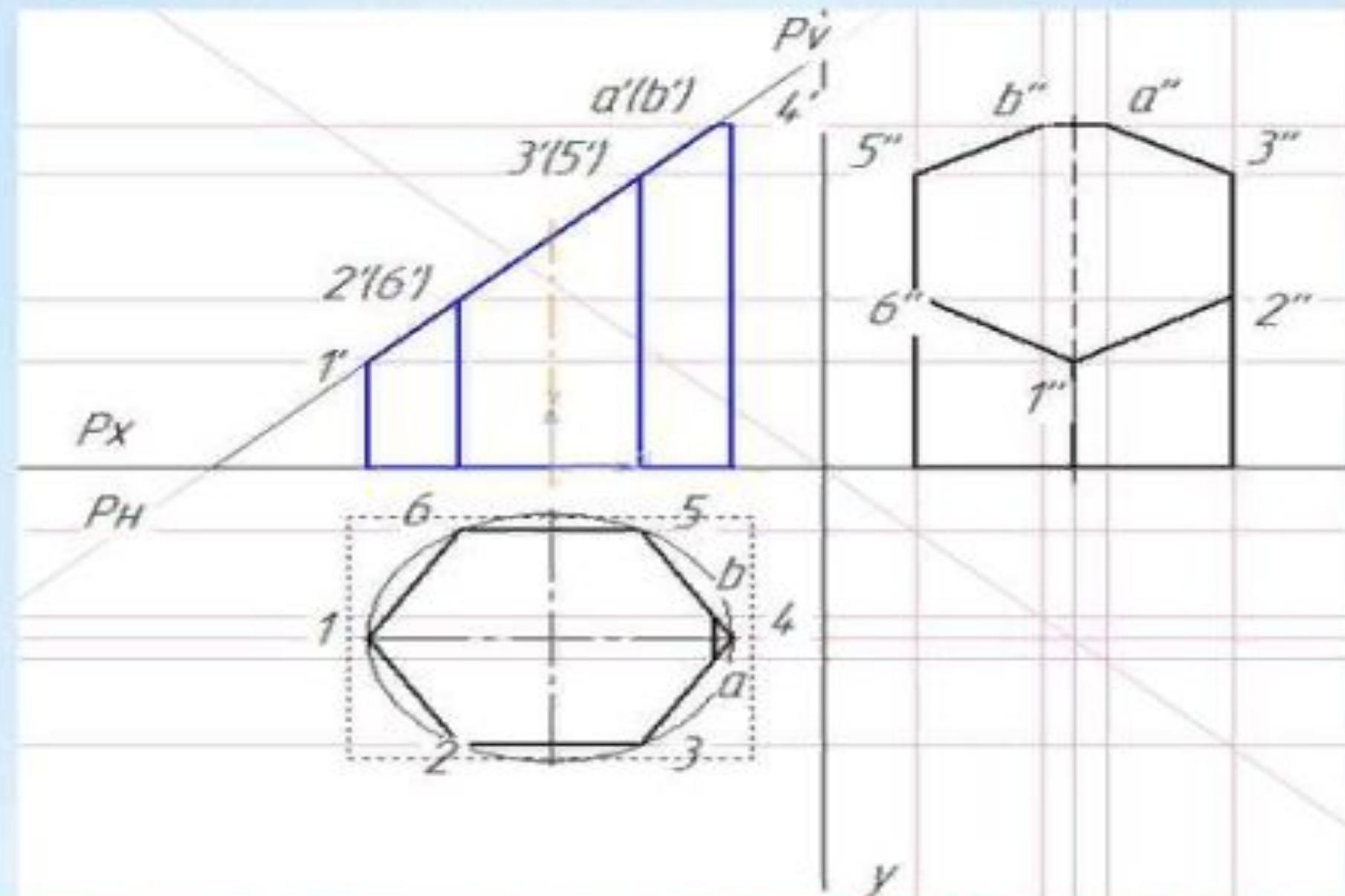
Таким образом, получаем искаженные фигуры сечения призмы плоскостью в проекциях.
