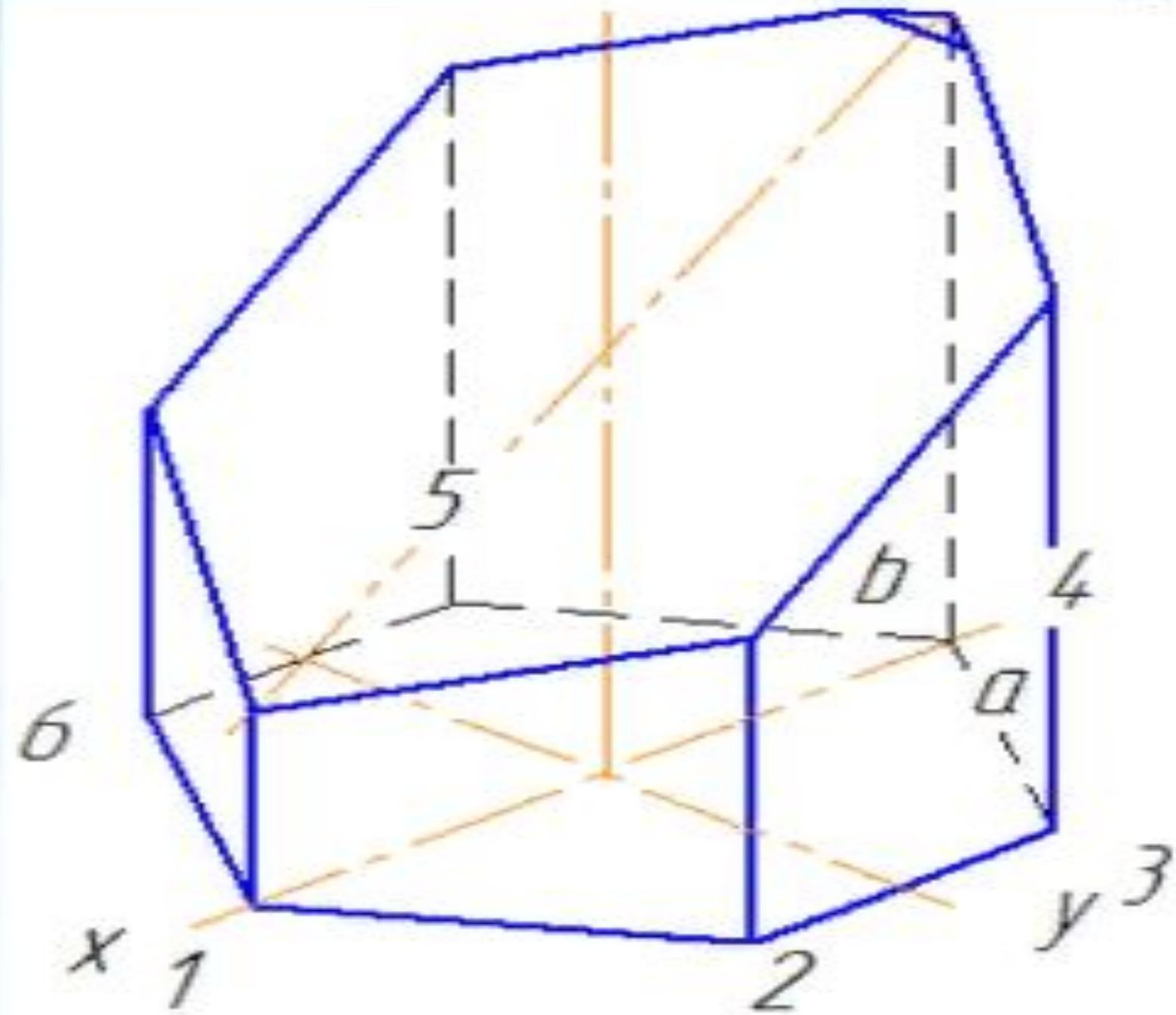
Обозначаем точки пересечения секущей плоскости с ребрами призмы на фронтальной проекции призмы и по линиям связи находим эти точки на оставшихся проекциях.
