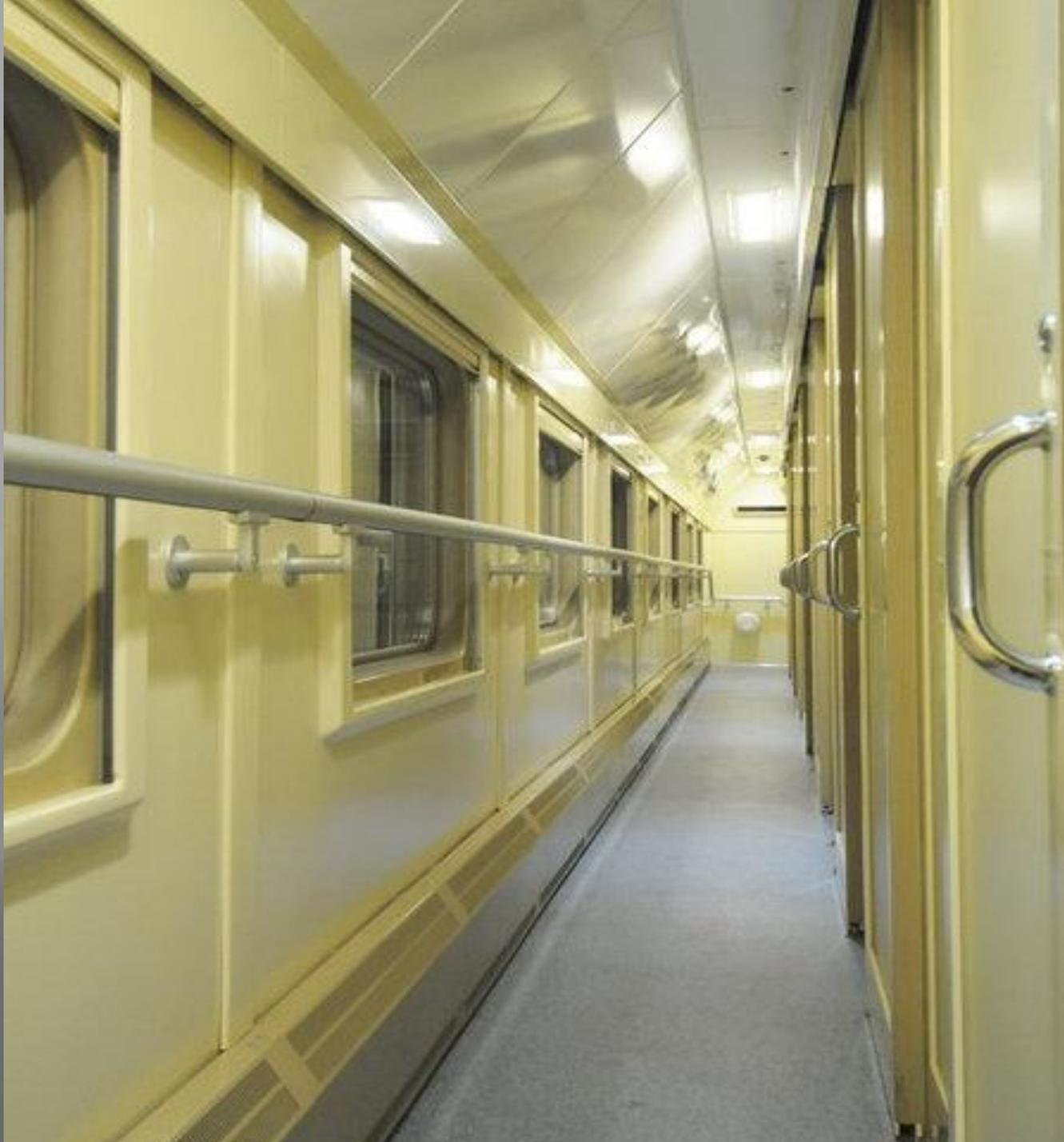
В высокоскоростном железнодорожном подвижном составе должен обеспечиваться безопасный проход обслуживающего персонала и пассажиров из вагона в вагон. Переходные площадки должны иметь поручни и не должны иметь выступающие части, которые могут привести к травмам обслуживающего персонала и пассажиров
