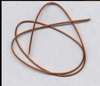
*Механическое воздействие вызывает смещение слоев атомов металлической кристаллической решетки и не сопровождается разрывом связи.*
