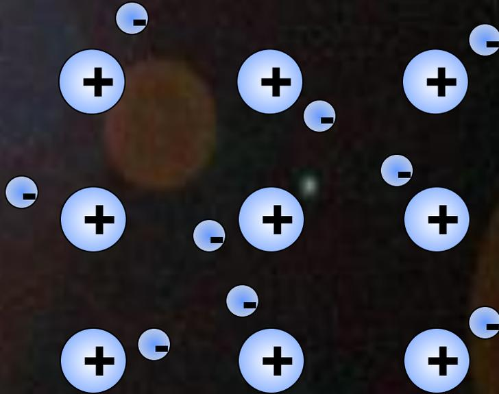
Связь в металлах и сплавах между ионами (атомами) посредством обобществленных электронов называется **металлической**.
