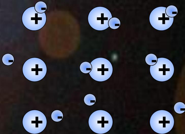
Связь в металлах и сплавах между ионами (атомами) посредством обобществленных электронов называется **металлической**.
