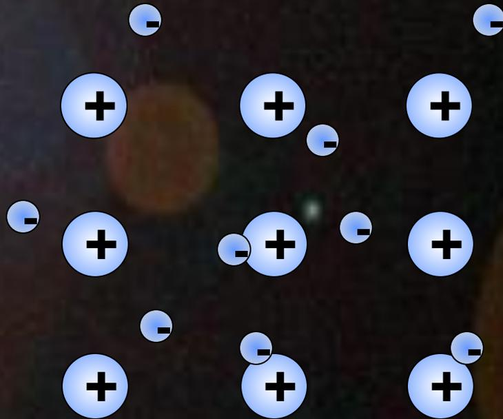
Связь в металлах и сплавах между ионами (атомами) посредством обобществленных электронов называется **металлической**.
