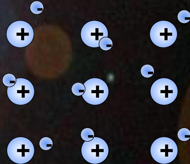
Связь в металлах и сплавах между ионами (атомами) посредством обобществленных электронов называется **металлической**.
