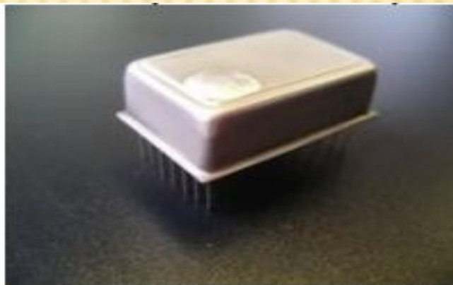
ММЭ в корпусе, полученный с использованием герметизации лазерной сваркой и пайкой припоем.
