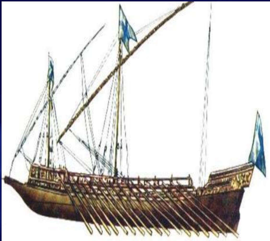
Скампавея — это военное быстроходное судно русского галерного флота XVIII века. Данные корабли использовались для перевозки войск, высадки десантов и их огневой поддержки. Длина судна не превышала 30 метров, ширина — до 5,5 метров. В движение скампавея приводилась 12-18 парами весел, помимо этого на борту имелись одна-две мачты с косыми парусами. Вооружение могло состоять из 1-2 малокалиберных пушек, обычно установленных в носовой части корабля. На борту скамповеи могло
