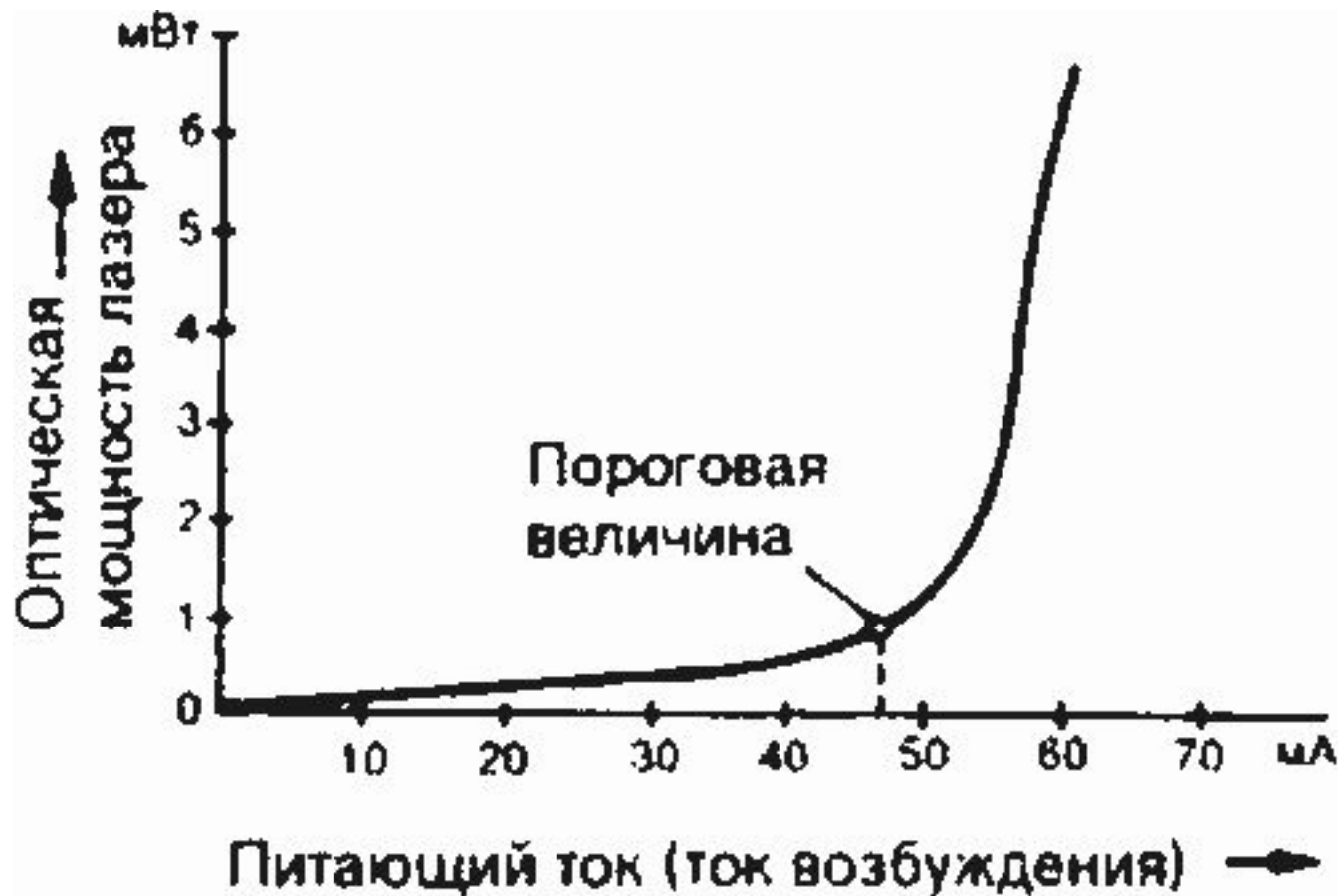
Рис.11 Характеристика эмиссионной способности инжекционного лазерного диода
