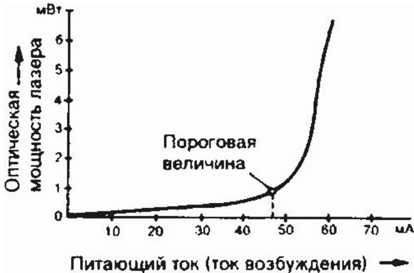
Рис.11 Характеристика эмиссионной способности инжекционного лазерного диода
