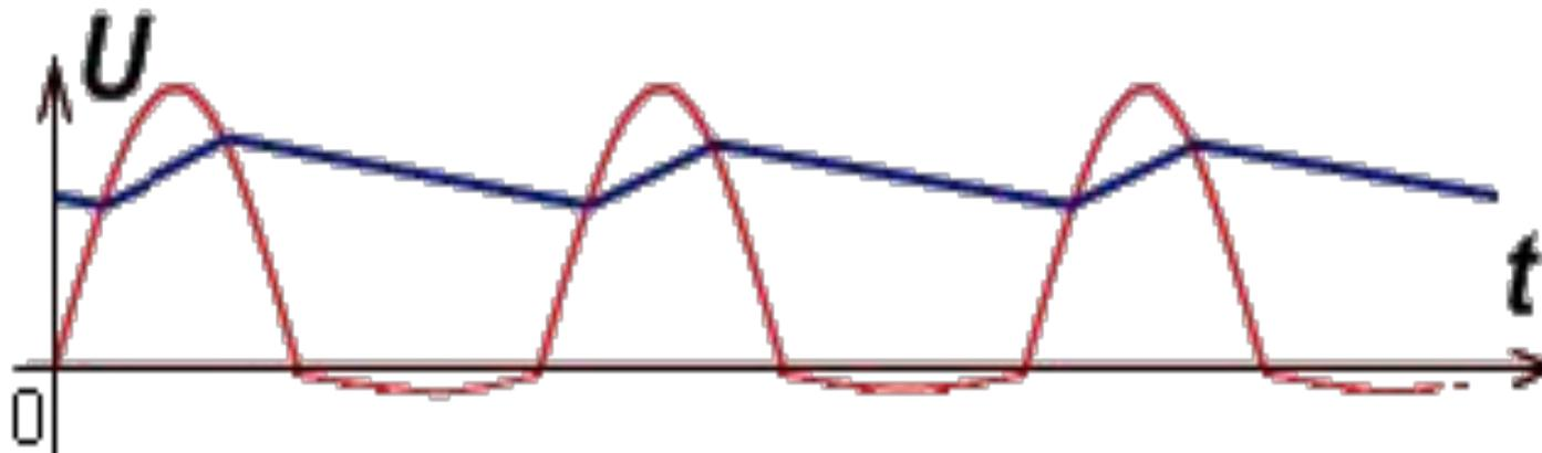
Красным цветом показано напряжение на выходе выпрямителя без сглаживающего конденсатора, а синим – при его наличии.
