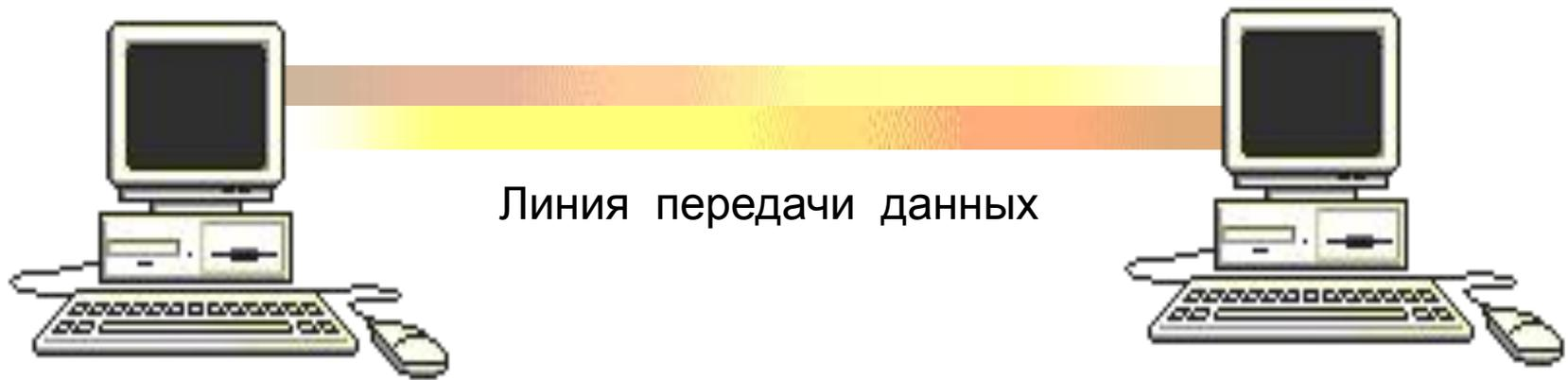
**Скорость передачи информации** (пропускная способность канала) - количество информации в битах в секунду (бит/с) и в производных единицах (Кбит/с, Мбит/с, Гбит/с):
