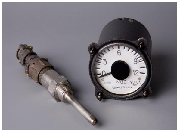
Термоуказатель ТУЭ-48 с терморезистором ТПП-2
