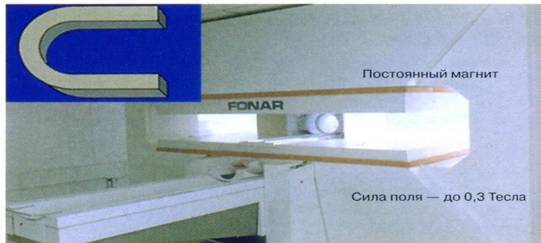
Рис. 24-37. Постоянный магнит (сила поля — до 0,3 Тесла)
