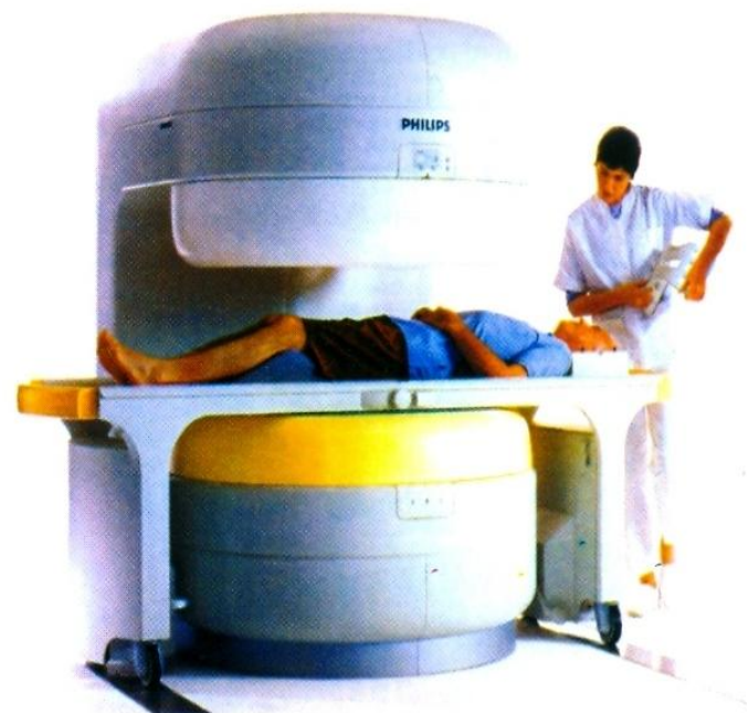
Рис. 24-40. Открытая МР-система 0,23 Тесла (с разрешения Philips Medical Systems)
