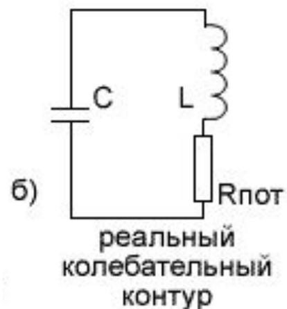
Колебательный контур - это устройство, предназначенное для генерации (создания) электромагнитных колебаний. С момента его создания и по сегодняшний день он используется во многих областях науки и техники: от повседневной жизни до огромных заводов, производящих самую разную продукцию.
