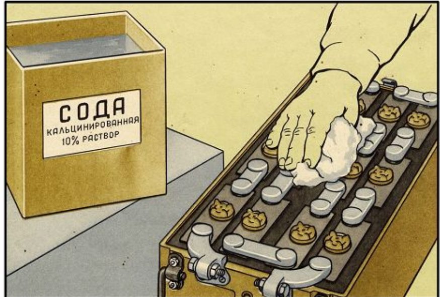
Нейтрализация поверхности батареи. Пробки аккумуляторов должны быть ввернуты
