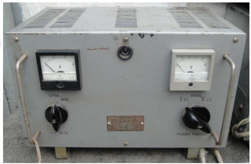
Зарядное устройство с не регулируемым выходным напряжением
