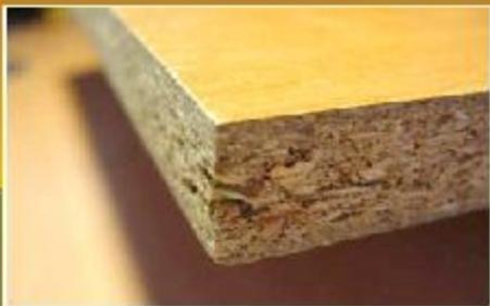
ДСП - это древесно - стружечная плита, которую изготавливают из деревянной стружки и клеящего состава, путём горячего прессования.
