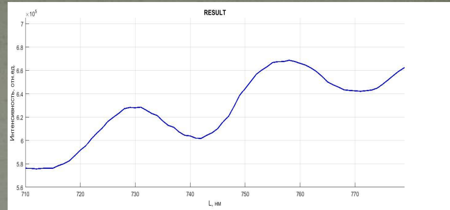
Спектр алмазной пленки, выращенной на сапфировой подложке с адгезионным подслоем кремния, не содержащей в себе SiV-центры.
