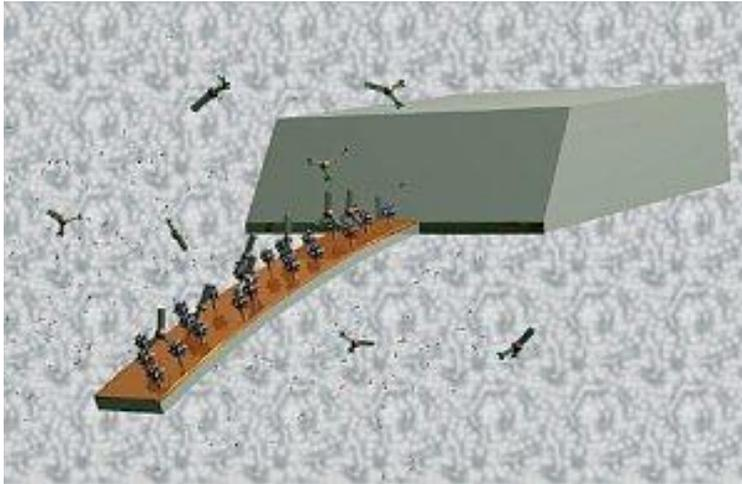
Как только на поверхность колеблющегося кантилевера попадает бактерия, то частота его колебаний изменяется. Благодаря этому можно понять, что на кантилевер что-то попало, и точно определить массу объекта
