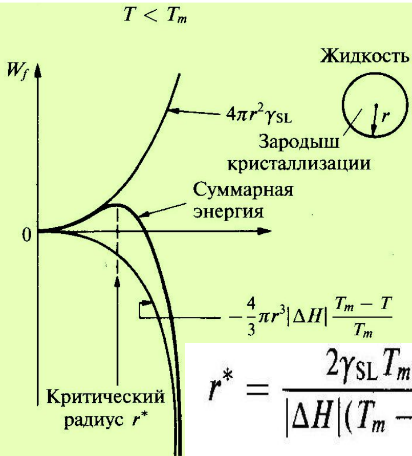
Рис. 38.1. Энергия образования сферического зародыша кристаллизации
