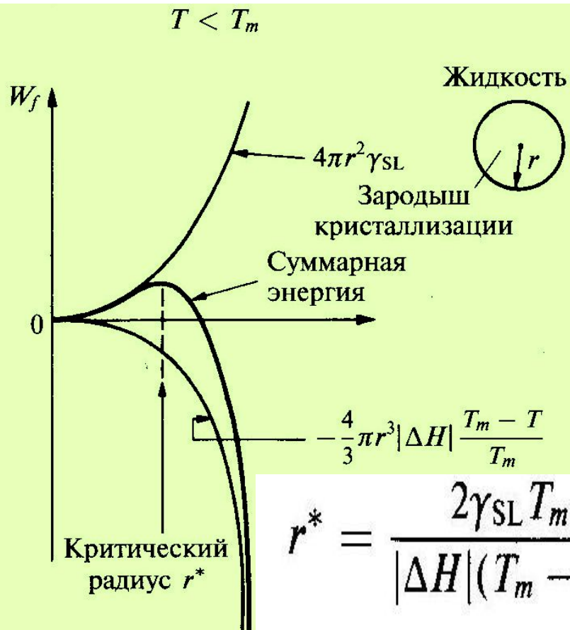
Рис. 38.1. Энергия образования сферического зародыша кристаллизации
