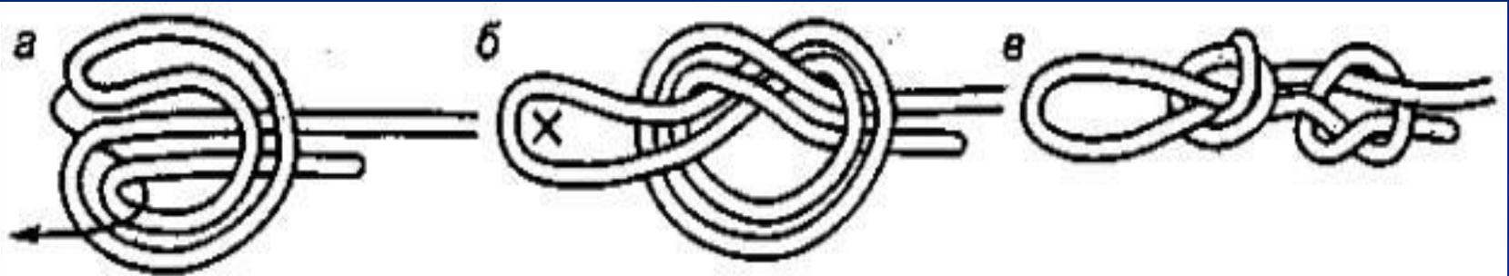
Рис. 60. «Простой проводник»
