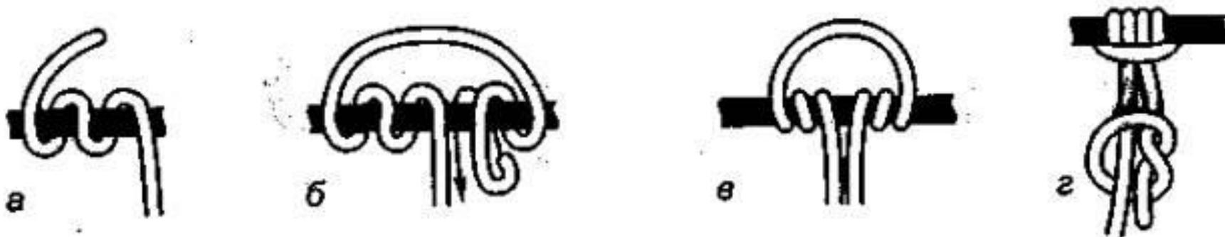
Рис. 70. «Схватывающий» узел одним концом
