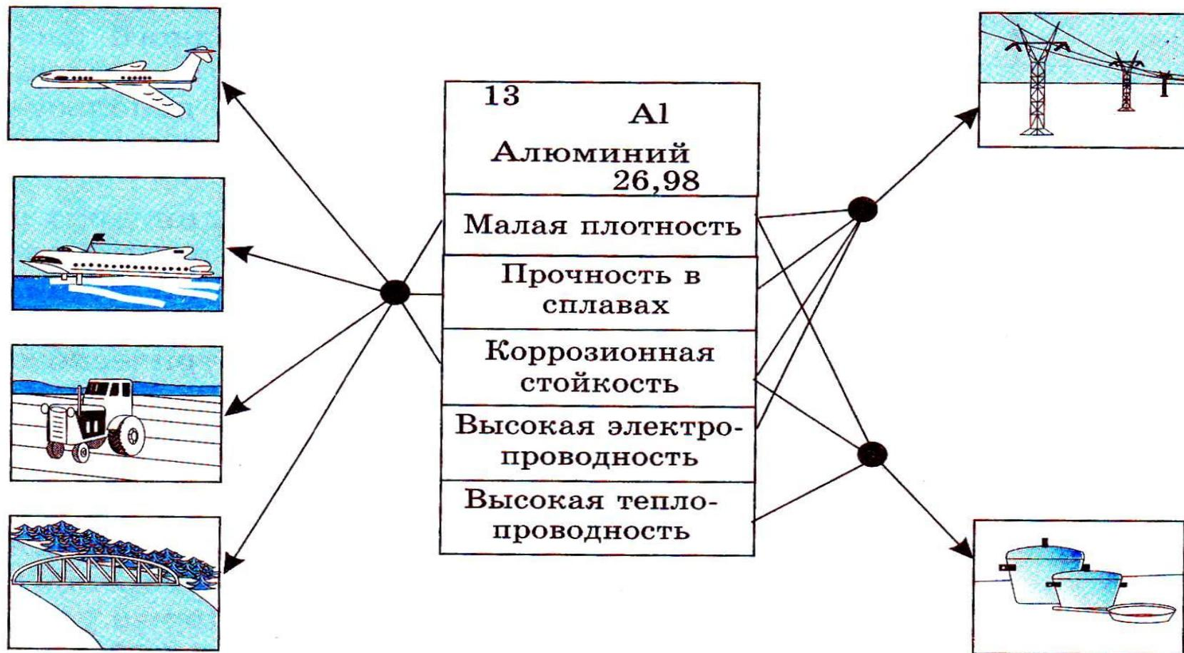
Рис. 15. Основные области применения алюминия и его сплавов
