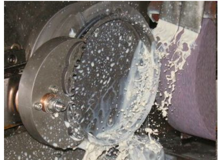
Башмаки для точного шлифования колец подшипников.
