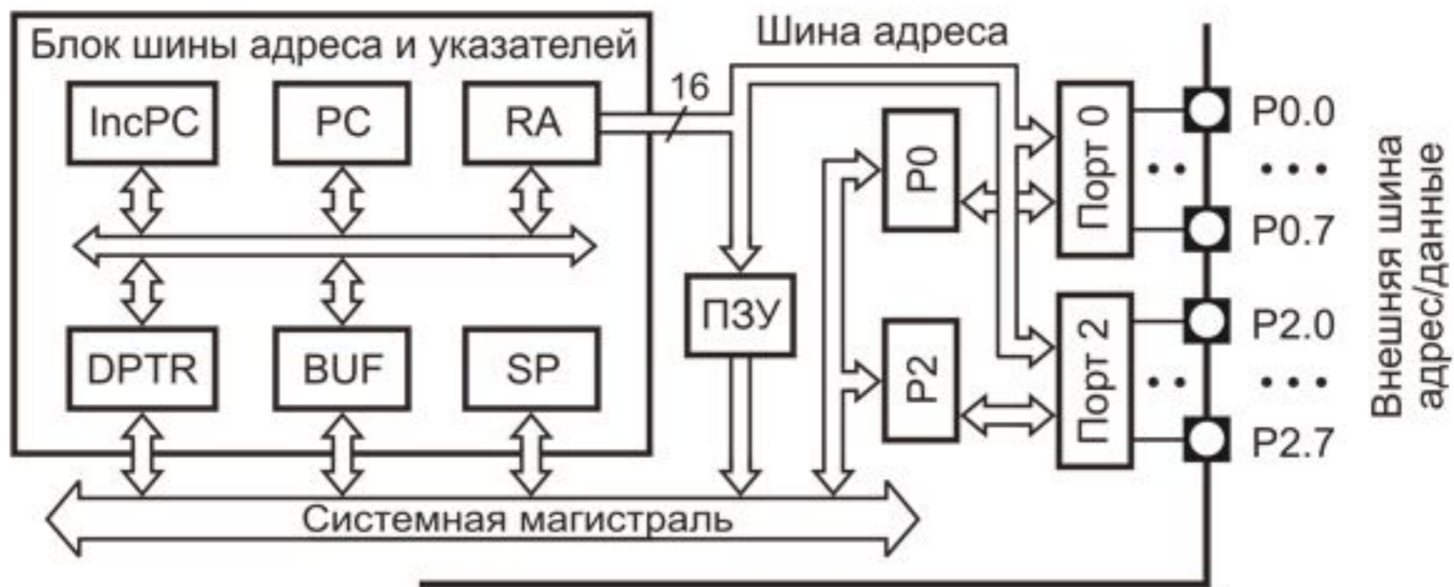
Рис. 2.6. Структура блока шины адреса и указателей
