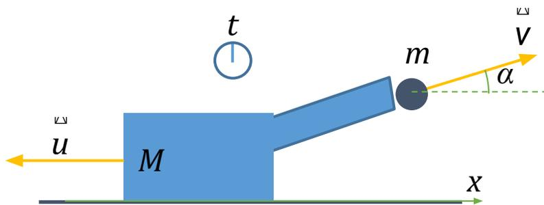
Объект исследования: механическая система — пушка (ТТ) + снаряд (МТ)
