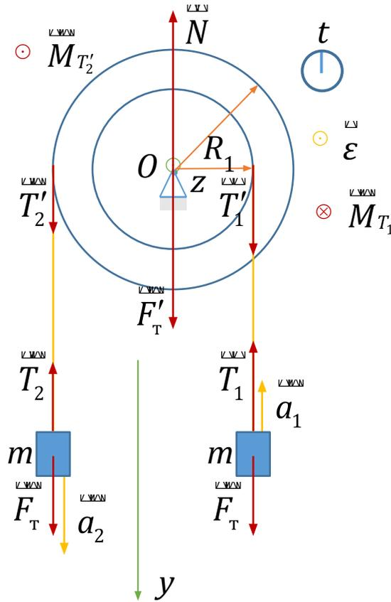
ОУДВД (для блока):  $\vec{\epsilon} = \vec{M}_{F_T} + \vec{M}_N + \vec{M}_{T_1'} + \vec{M}_{T_2'}$
