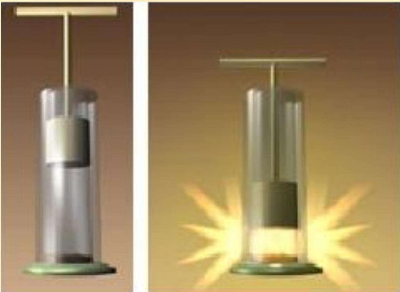
**Опыт "воздушное огниво"**. Возьмем толстостенный стеклянный цилиндр с поршнем. На дно цилиндра насыплем измельченной "серы" от спичек. Резко ударив по рукоятке, мы сильно сожмем воздух. В результате он нагревается настолько сильно, что серный порошок воспламеняется.
