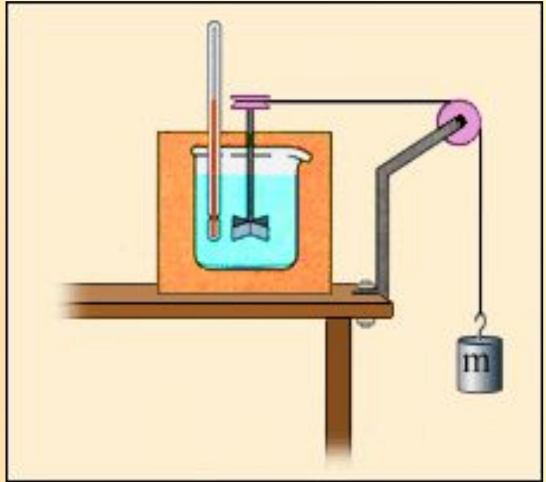
**Механический эквивалент теплоты  $A/Q$**
