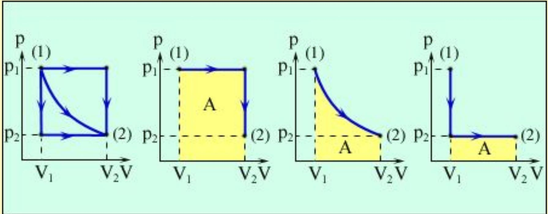
Процессы, изображенные на рисунке, можно провести и в обратном направлении; тогда работа  $A$  просто изменит знак на противоположный. Процессы такого рода, которые можно проводить в обоих направлениях, называются **обратимыми**
