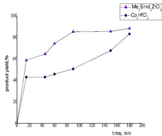
Выход продуктов реакции октена-1 с  $\text{Me}_2\text{SiInd}_2\text{ZrCl}_2\text{-AlBu}_3^i$  и  $\text{Cp}_2\text{HfCl}_2\text{-AlBu}_3^i$  в присутствии 240 экв MAO.
