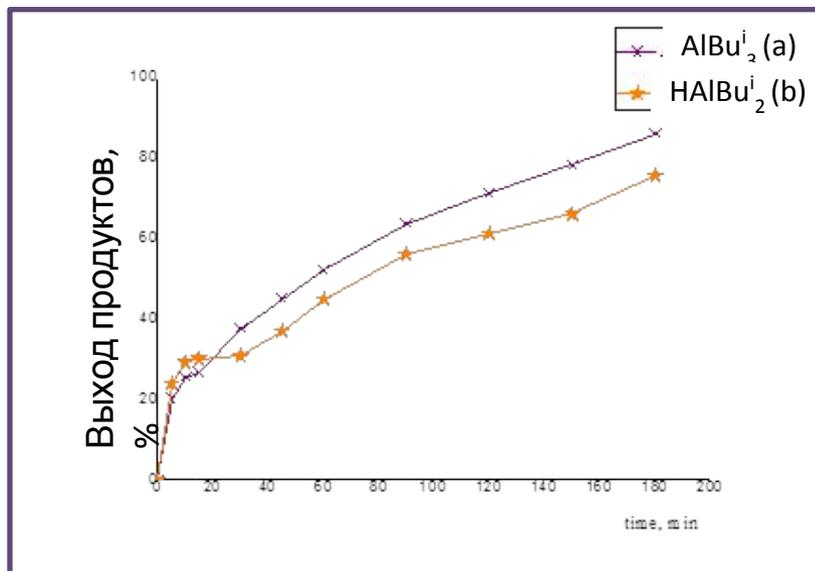
Выход продуктов гидроалюминирования октена-1 в присутствии системы на основе  $\text{Ind}_2\text{ZrCl}_2$  и 60 экв MAO в присутствии  $\text{AlBu}_3^i$  (a) или  $\text{HAIBu}_2^i$  (b).
