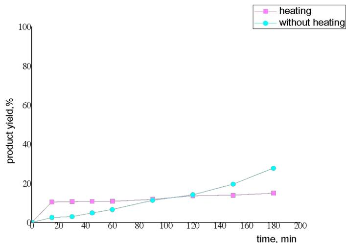
Выход продуктов реакции октена-1 с  $\text{Cp}_2\text{ZrCl}_2\text{-AlBu}^i_3$
