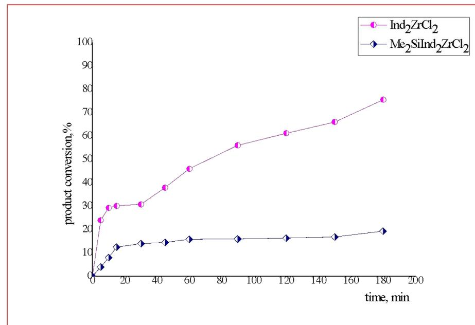
Сравнение каталитических систем на основе Ind<sub>2</sub>ZrCl<sub>2</sub> и Me<sub>2</sub>SiInd<sub>2</sub>ZrCl<sub>2</sub> с AlBu<sub>3</sub><sup>i</sup>.
