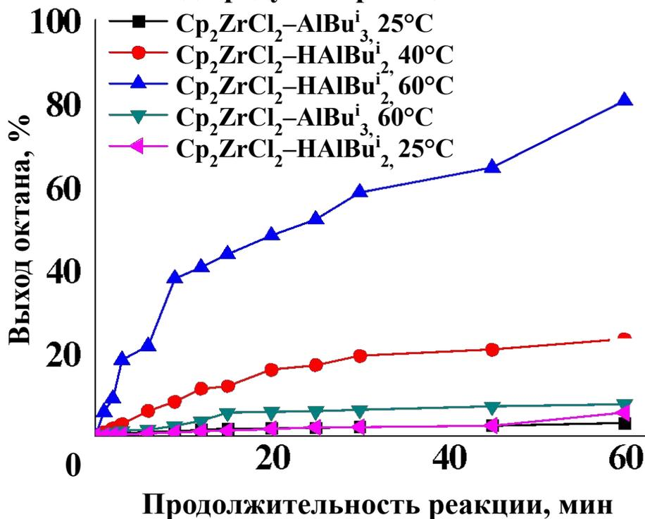
Выход продуктов реакции октена-1 при  $60^\circ\text{C}$
