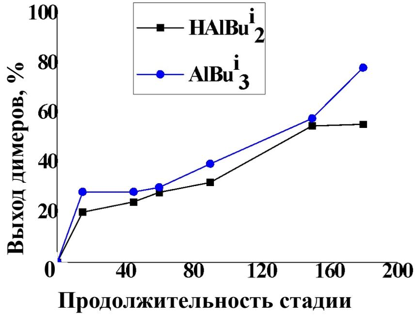
Реакция гидроалюминирования непредельных соединений с помощью  $X_nAlBu^i_{3-n}$  ( $X=H, Bu^i$ ) в присутствии циклопентадиенильных комплексов Zr в зависимости от условий реакции.
