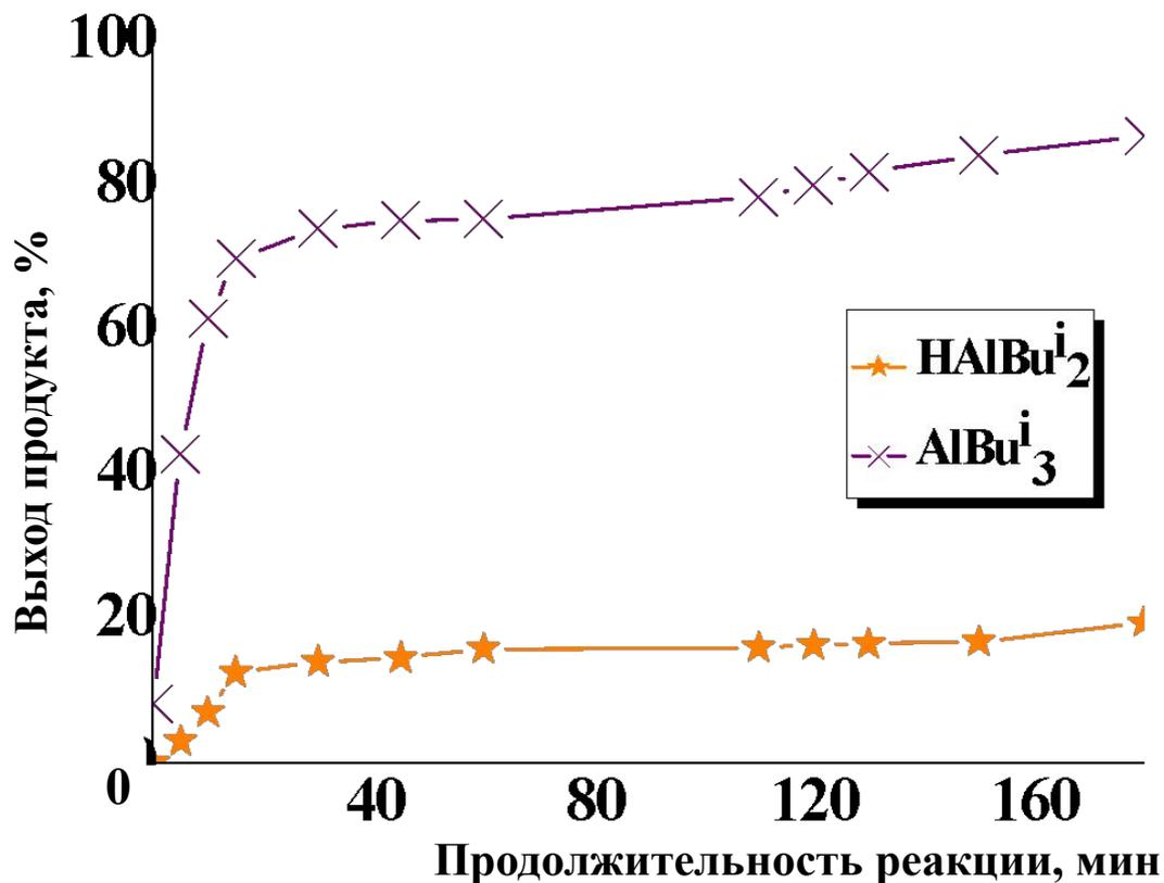
**Выход продуктов гидроалюминирования октена-1 в присутствии системы на основе  $Me_2SiInd_2ZrCl_2$  и  $XAlBu^i_2$  ( $X=H, Bu^i$ ) в присутствии 60 экв MAO.**
