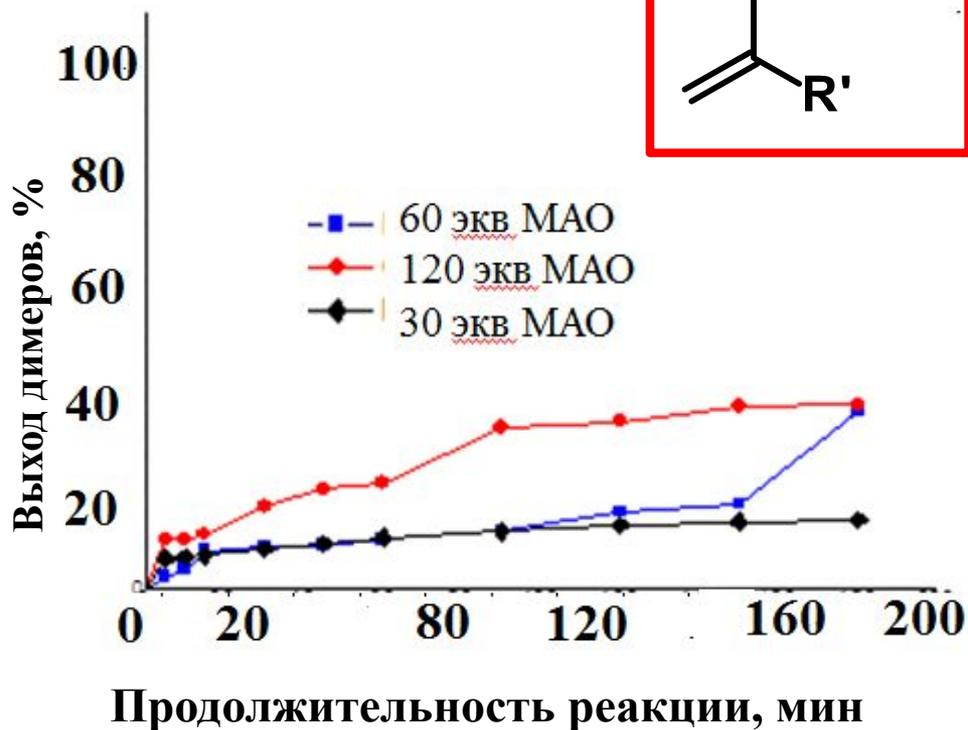
Выход димеров октена-1 в присутствии каталитической системы  $\text{Ind}_2\text{ZrCl}_2\text{-HAlBu}^i_2$  в зависимости от концентрации MAO.
