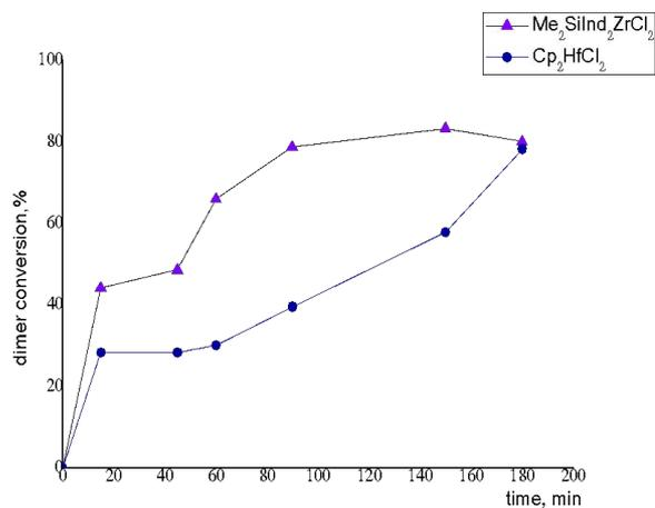
Выход димеров октена-1 в присутствии каталитических систем с  $\text{Me}_2\text{SiInd}_2\text{ZrCl}_2\text{-AlBu}_3^i$  и  $\text{Cp}_2\text{HfCl}_2\text{-AlBu}_3^i$  в присутствии 240 экв MAO.
