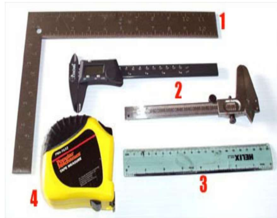
Угловая линейка(1), прямая линейка(3), штангенциркули(2) и рулетка(4).
