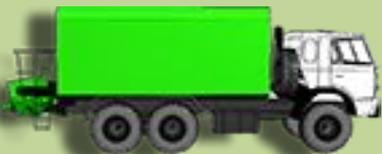
**Автомобильный тампонирующий насос (АТН) – агрегат, предназначенный для ликвидации зон поглощения при бурении скважин на нефть и газ.**
