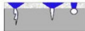
Нанесение проявителя и инспектирование
