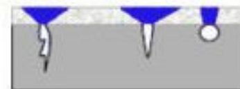
Нанесение проявителя и инспектирование
