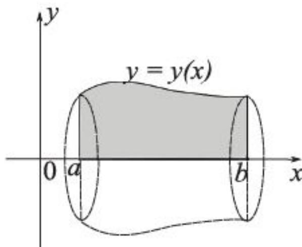
Аналогично, если криволинейная трапеция, ограниченная кривой  $x = x(y)$  и прямыми  $y = c$ ,  $y = d$ ,  $x = 0$ , вращается вокруг оси  $Oy$ , то объем тела вращения может быть вычислен по формуле
