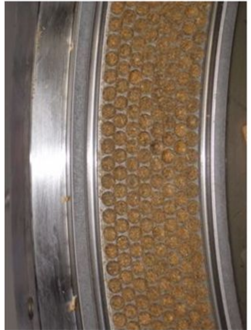
Сурет 13.5-Матрица мен престоуші роликтердің жалпы көрінісі
