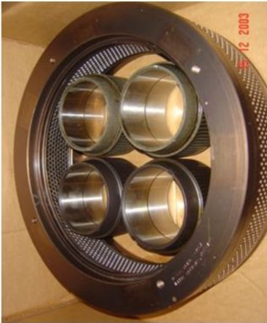
Сурет 13.5-Матрица мен престоуші роликтердің жалпы көрінісі
