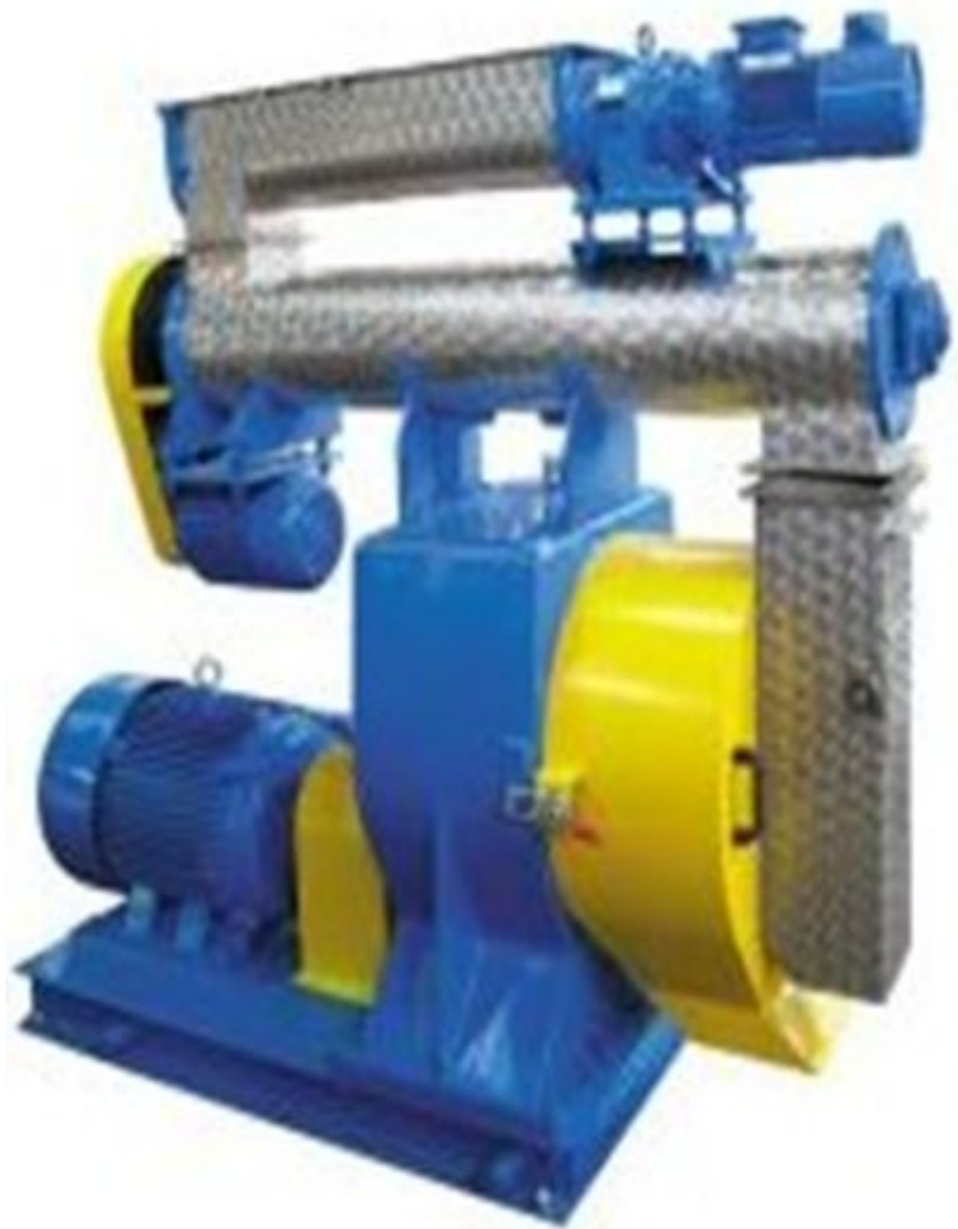
Сурет 13.6-Пресс-гранулятордың жалпы көрінісі
