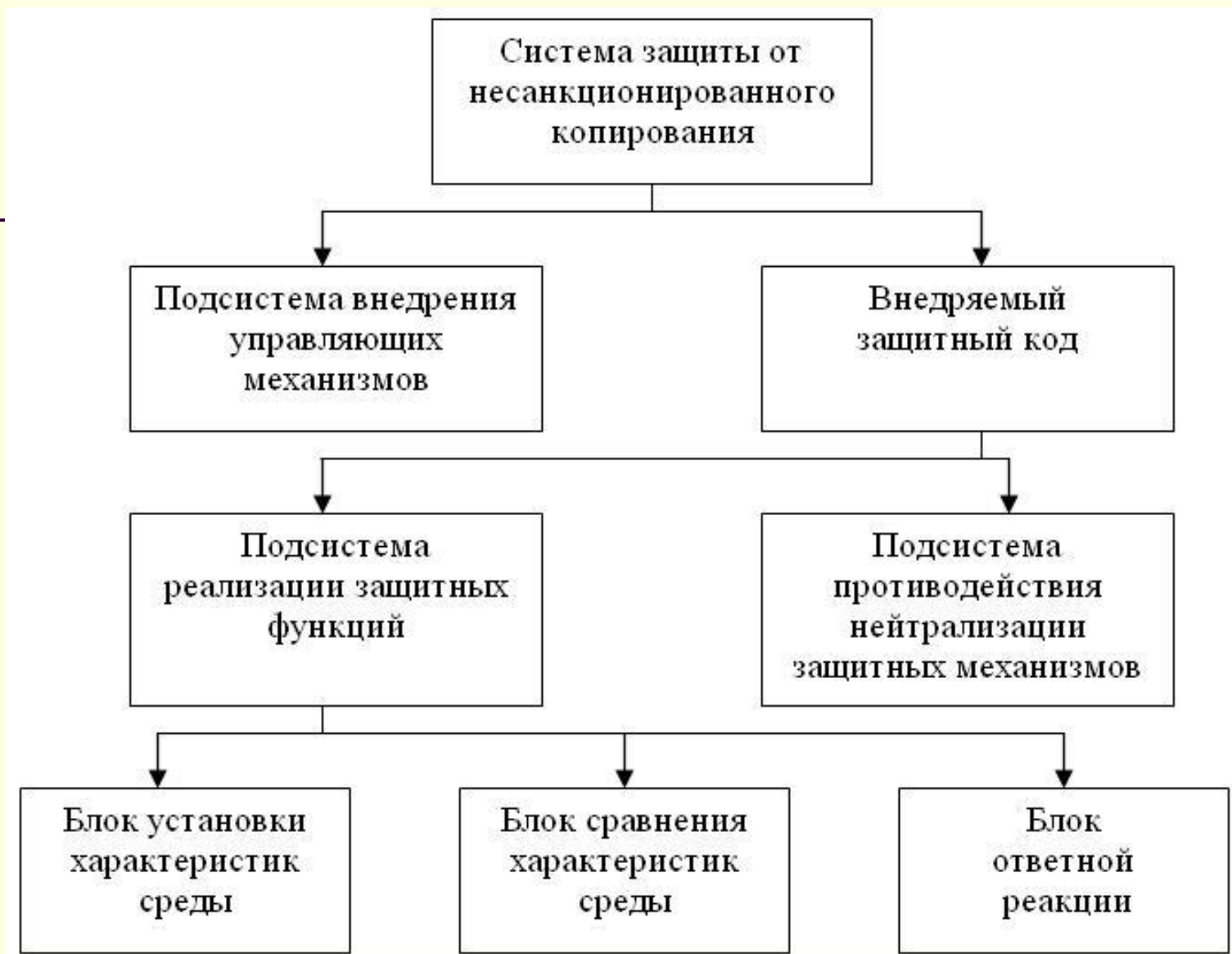
Рис.1. Структура системы защиты от несанкционированного копирования
