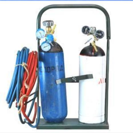
Баллоны для хранения и транспортировки сжатых, сжиженных и растворенных газов регламентируются требованиями ГОСТ 949-73. Вместимость баллонов может быть различной и колеблется от 0,4 до 55 дм<sup>3</sup>. Их изготавливают из бесшовных углеродистых или легированных труб под условное давление до 20 МПа (200 кг с/м<sup>2</sup>). Для передвижных сварочных установок наибольшее распространение получили баллоны емкостью 40 дм<sup>3</sup>.
