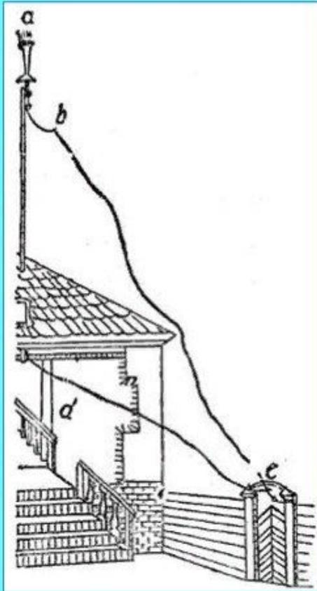
Ломоносов впервые предложил **молниеотвод** – для отвода «электрической силы на шест с железом».
