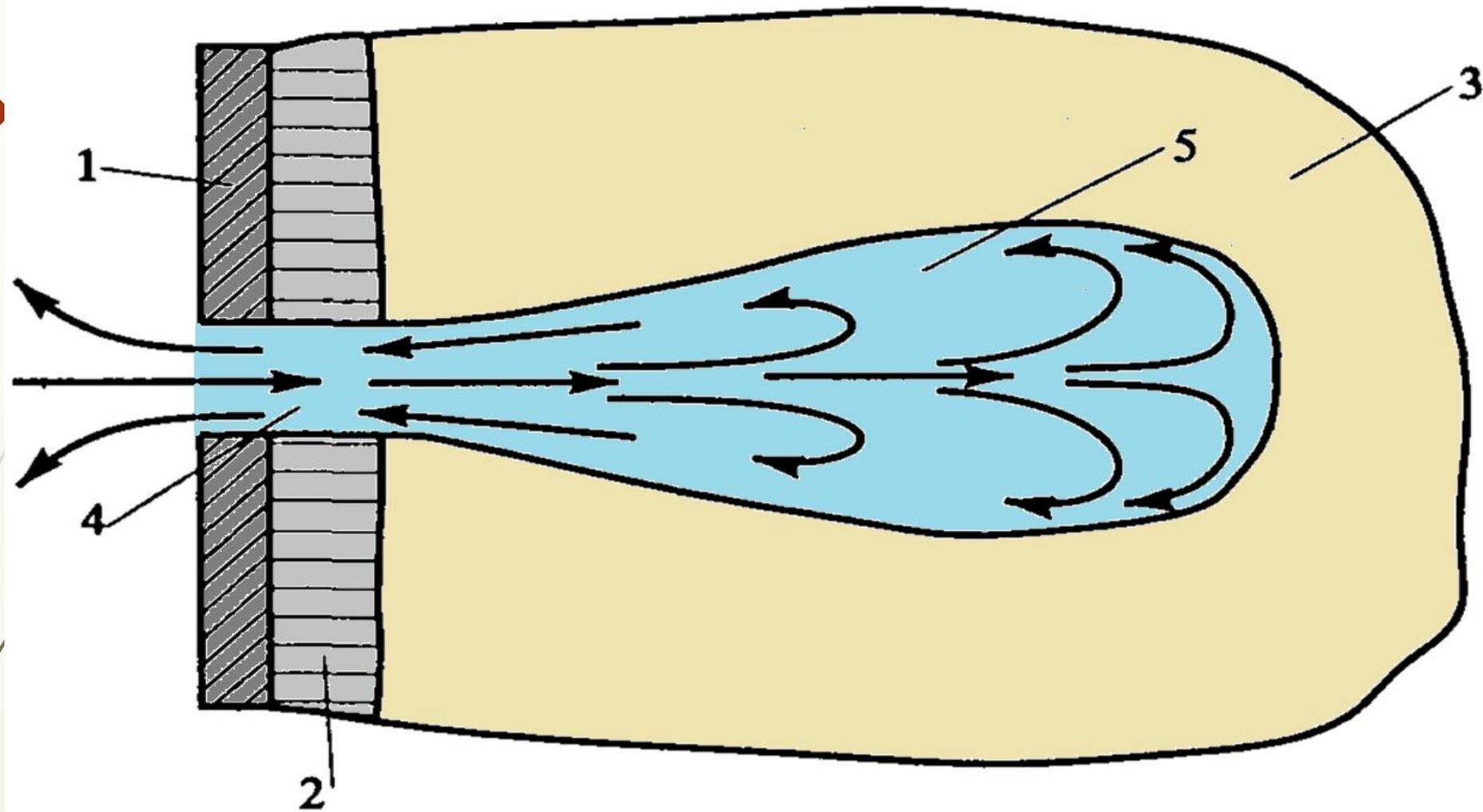
**Схема образования грушеобразной каверны в породе при гидropескоструйной перфорации:**
