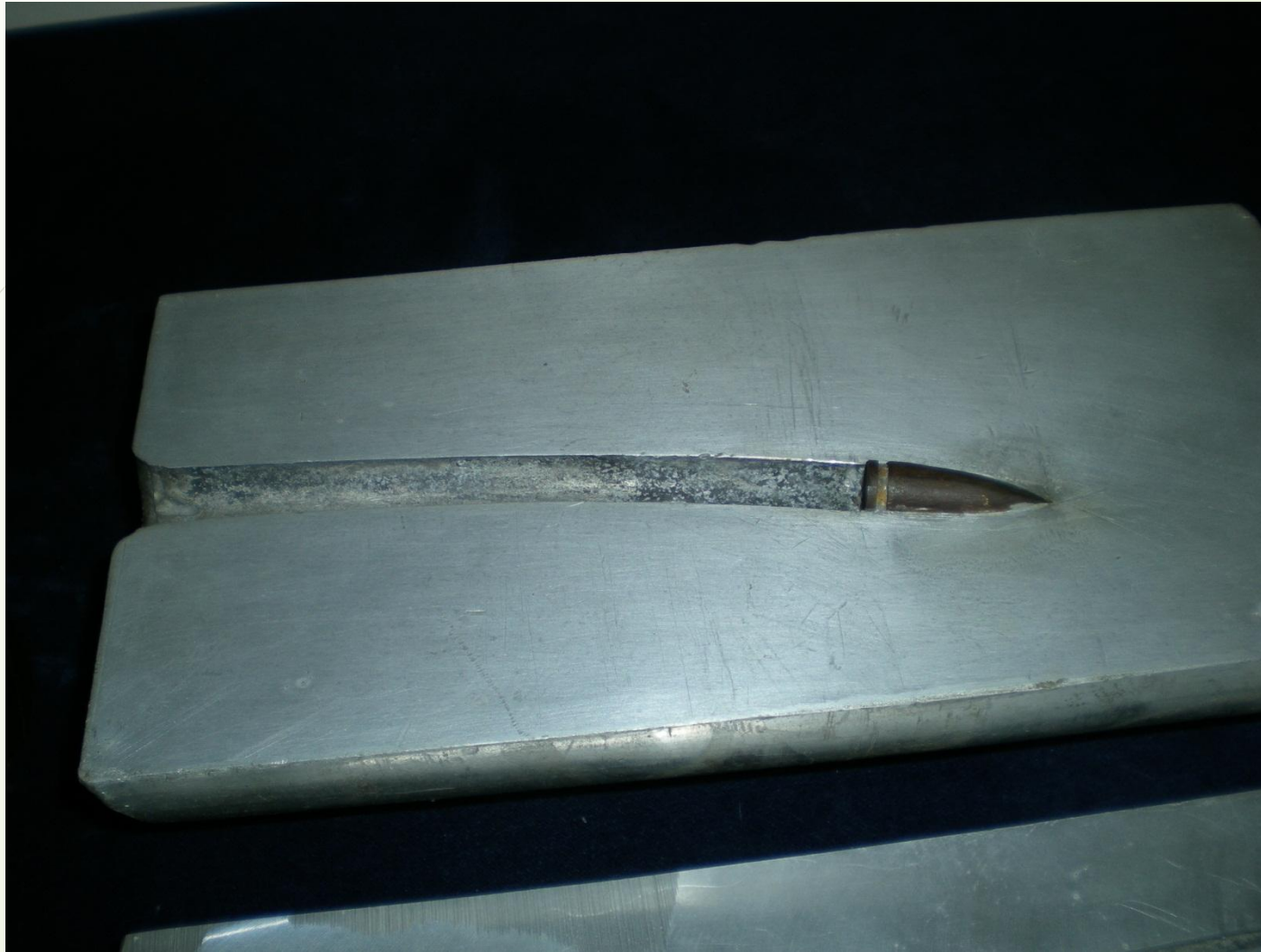
Канал, образованный в горной породе при пулевой перфорации (Шлюмберже)
