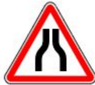
Знак 1.20.1. Сужение дороги.
