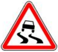
Знак 1.15. Скользкая дорога
