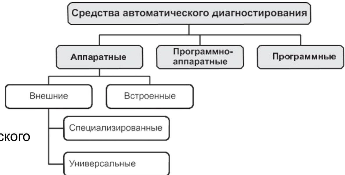
Рис. 2.4. Классификация средств автоматического диагностирования
