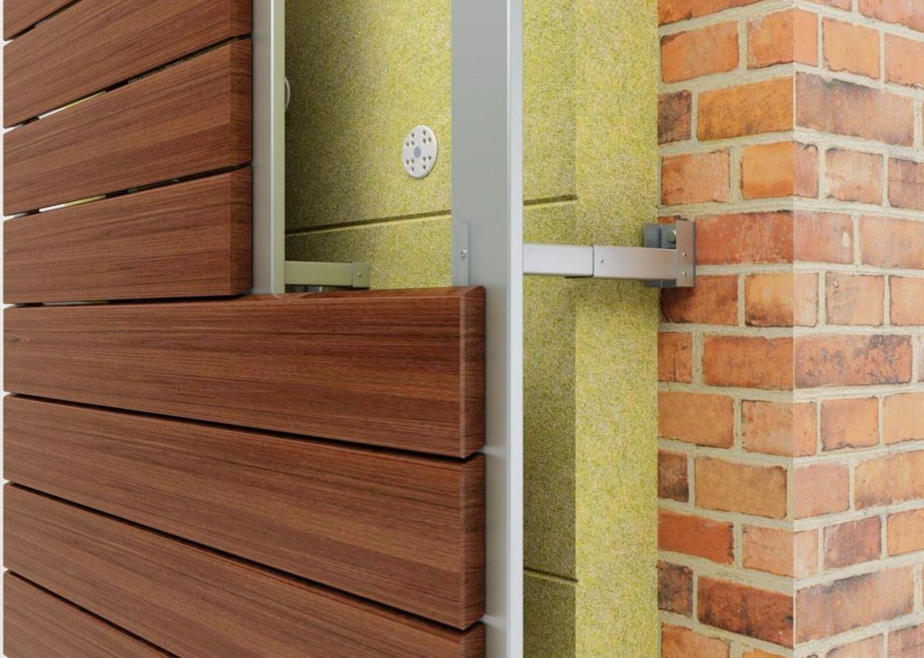
*Рис. Деревянный вентилируемый фасад.*
