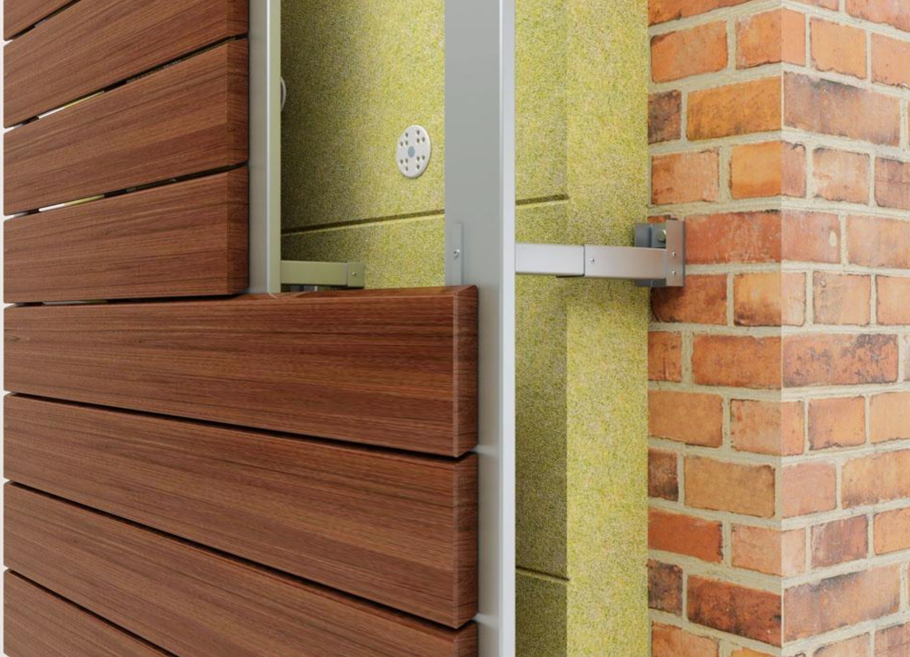
Рис. Деревянный вентилируемый фасад.
