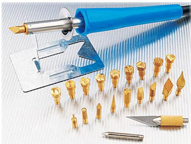
Для выполнения простых узоров, не требующих тонких линий и светотени, можно использовать – покер. Покер выжигает на дереве четкие, резкие линии. К покеру прилагается набор сменных насадок: иглы для выжигания линий, плоские наконечники для фона и фигурные насадки.
