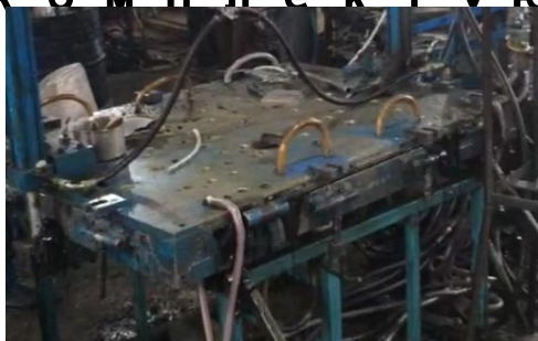
1.Повышение температуры пресс формы
