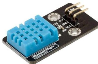
Датчик температуры и влажности воздуха DHT11
