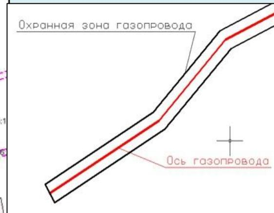
**Отсчет расстояний при определении охранных зон газопроводов производится от оси газопровода — для одноконтурных газопроводов и от осей крайних ниток газопроводов — для многоконтурных.**
