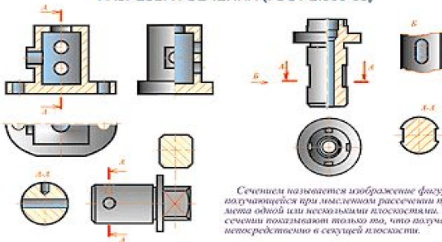
Сечением называется изображение фигуры, получаемой при мысленном рассечении предмета одной или несколькими плоскостями. На сечении показывают только то, что получается непосредственно в секущей плоскости.
