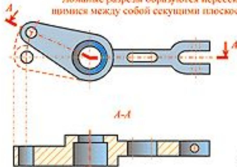
При ломанных разрезах секущие плоскости условно поворачивают до совмещения в одну плоскость, при этом направление поворота может не совпадать с направлением взгляда.
