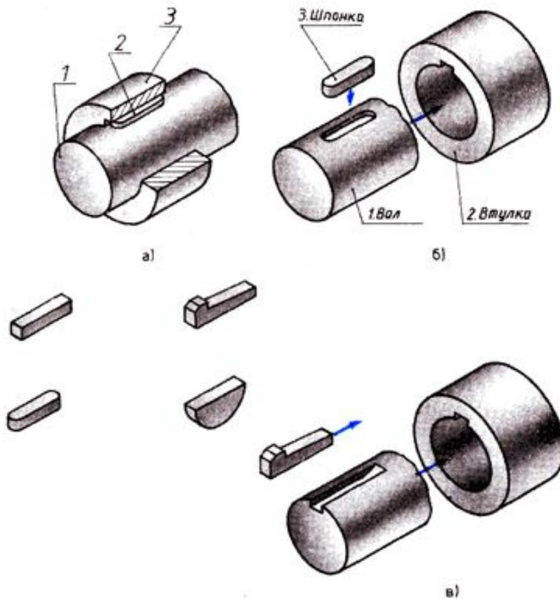
Шпоночное соединение — соединение деталей, осуществляемое посредством шпонки, которая устанавливается в шпоночном пазу вала и входит в шпоночную канавку присоединяемой детали.
