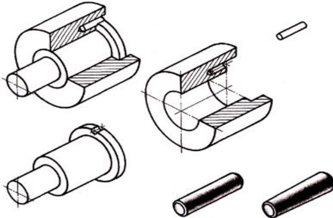
Рис. 215. Детали штифтового соединения
