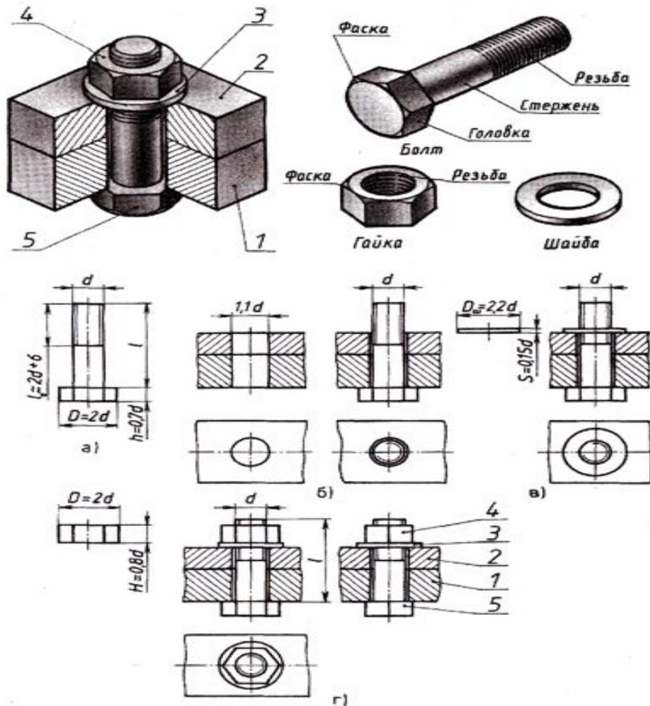
Рис. 210. Болтовое соединение
