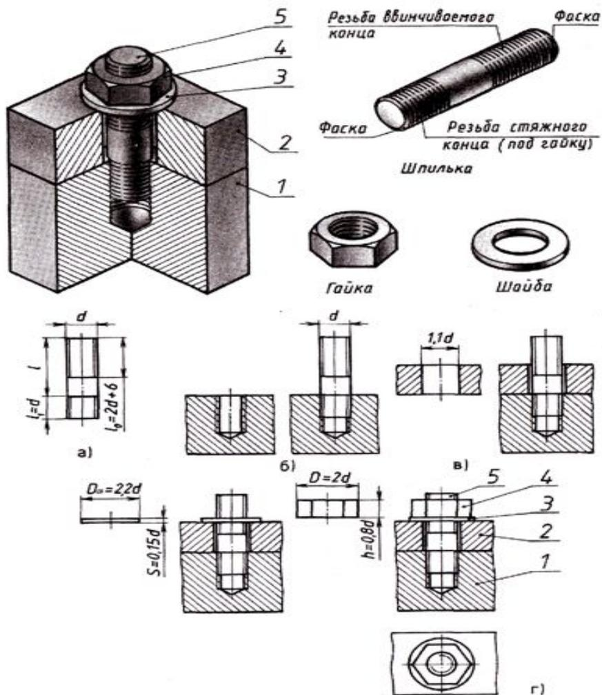
Шпильное соединение — соединение деталей, осуществляемое с помощью шпильки, один конец которой вворачивается в одну из соединяемых деталей, а на другой надевается присоединяемая деталь, шайба и затягивается гайка.
