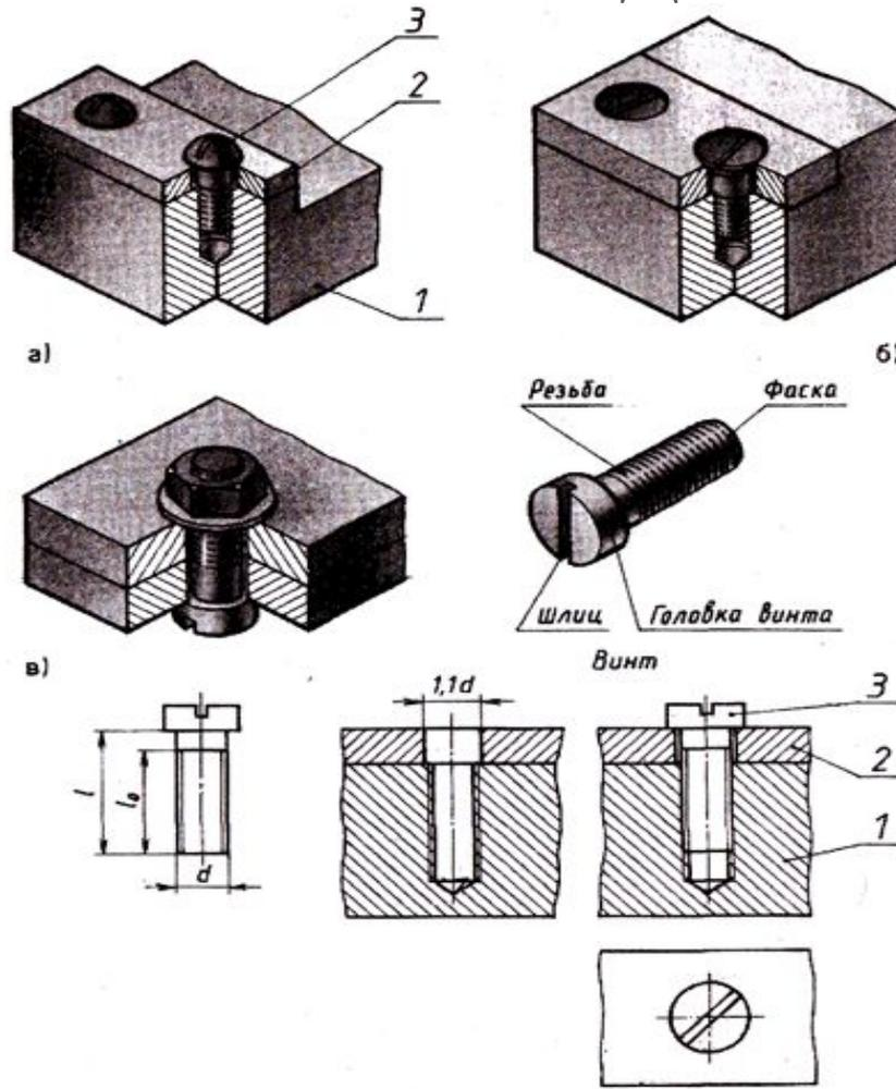
Винтовое соединение — соединение деталей, осуществляемое с помощью винта, ввинчиваемого в одну из соединяемых деталей, либо винта, шайбы и гайки.
