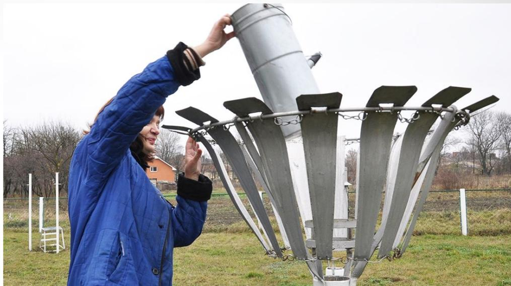
На метеорологических станциях количество выпавших осадков измеряют с помощью осадкомеров. На всех метеостанциях стоят осадкомерные ведра, из которых наблюдатель в срок 09 и 21 час по Гринвичу, выпавшие за 12-ти часовой период осадки выливает в специальный сосуд, по которому и измеряется истинное их количество. Твёрдые осадки, то есть снег, растапливаются и специалисты измеряют получившуюся воду.
