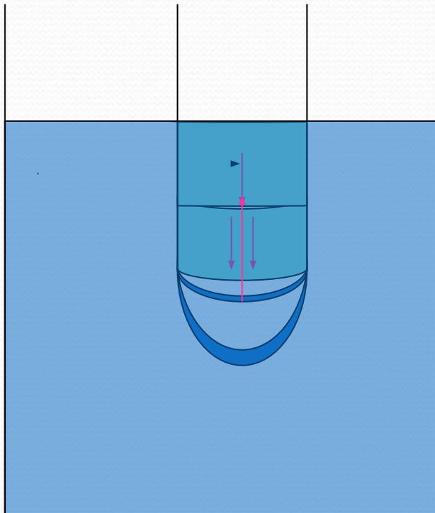
Если трубку погрузить в сосуд с водой так, чтобы уровни жидкости в трубке и в сосуде сравнялись, резиновое дно придёт в первоначальное состояние. Давление, оказываемое водой в сосуде снизу вверх сравняется с давлением воды на резиновое дно трубки.
