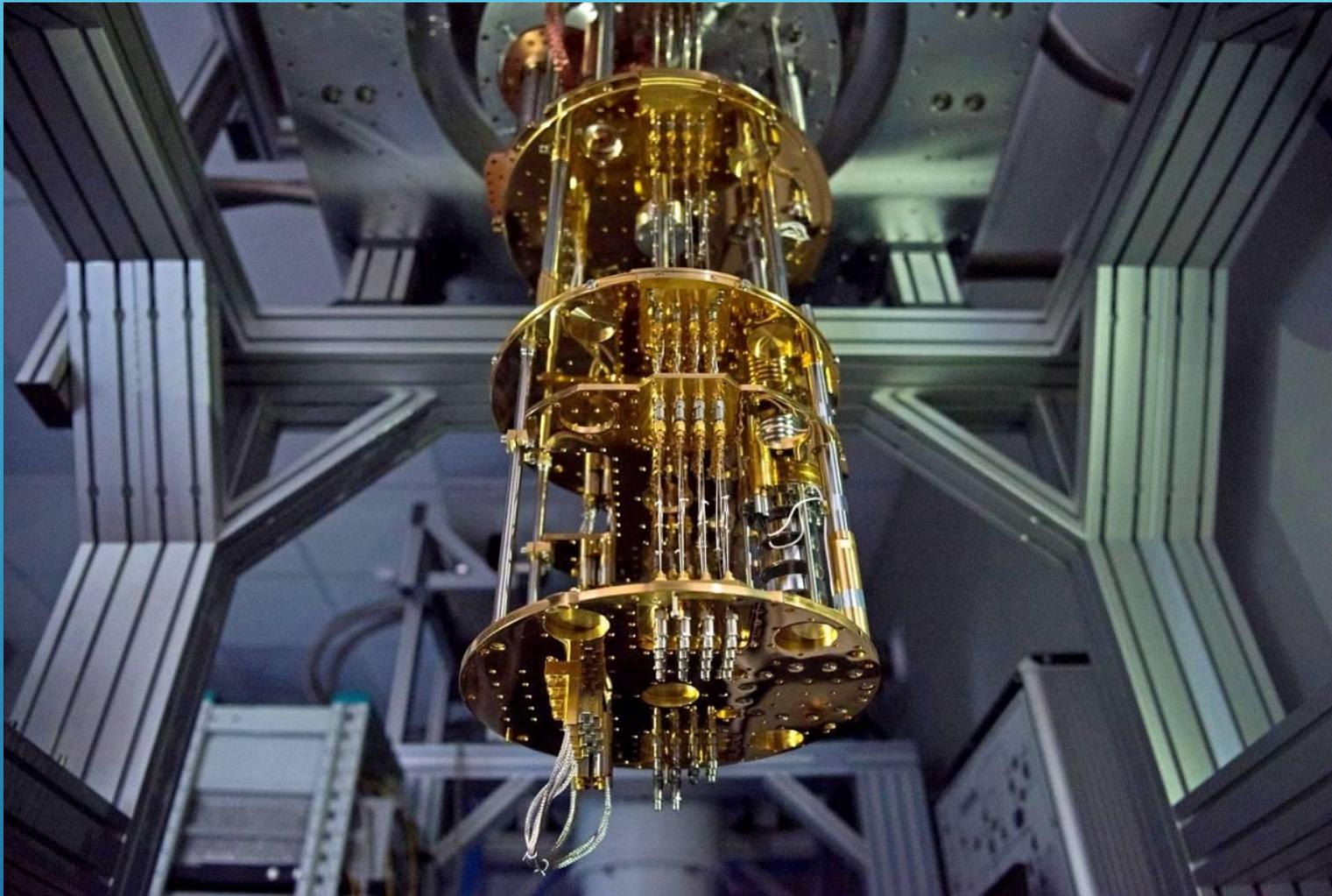
ПРОТОТИП КВАНТОВОГО КОМПЬЮТЕРА
