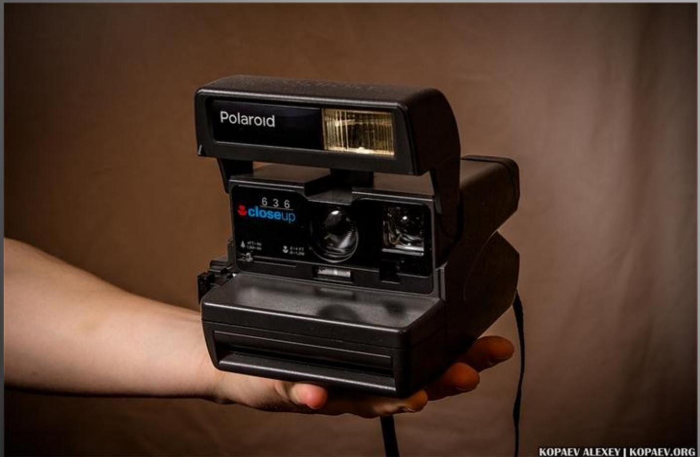
**Фотоаппараты системы Polaroid по конструкции значительно отличаются от пленочных фотоаппаратов и позволяют получать цветные позитивные изображения практически через 2... 3 мин после съемки в результате обработки специальных многослойных фотоматериалов непосредственно в фотоаппарате**
