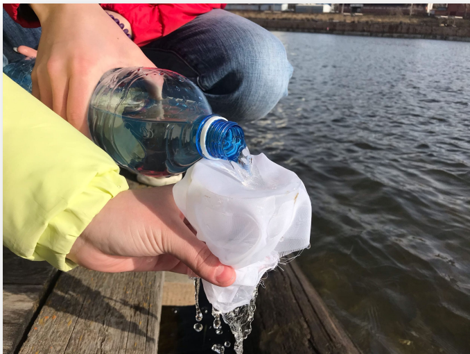
Самодельный фильтр для выявления микропластика
