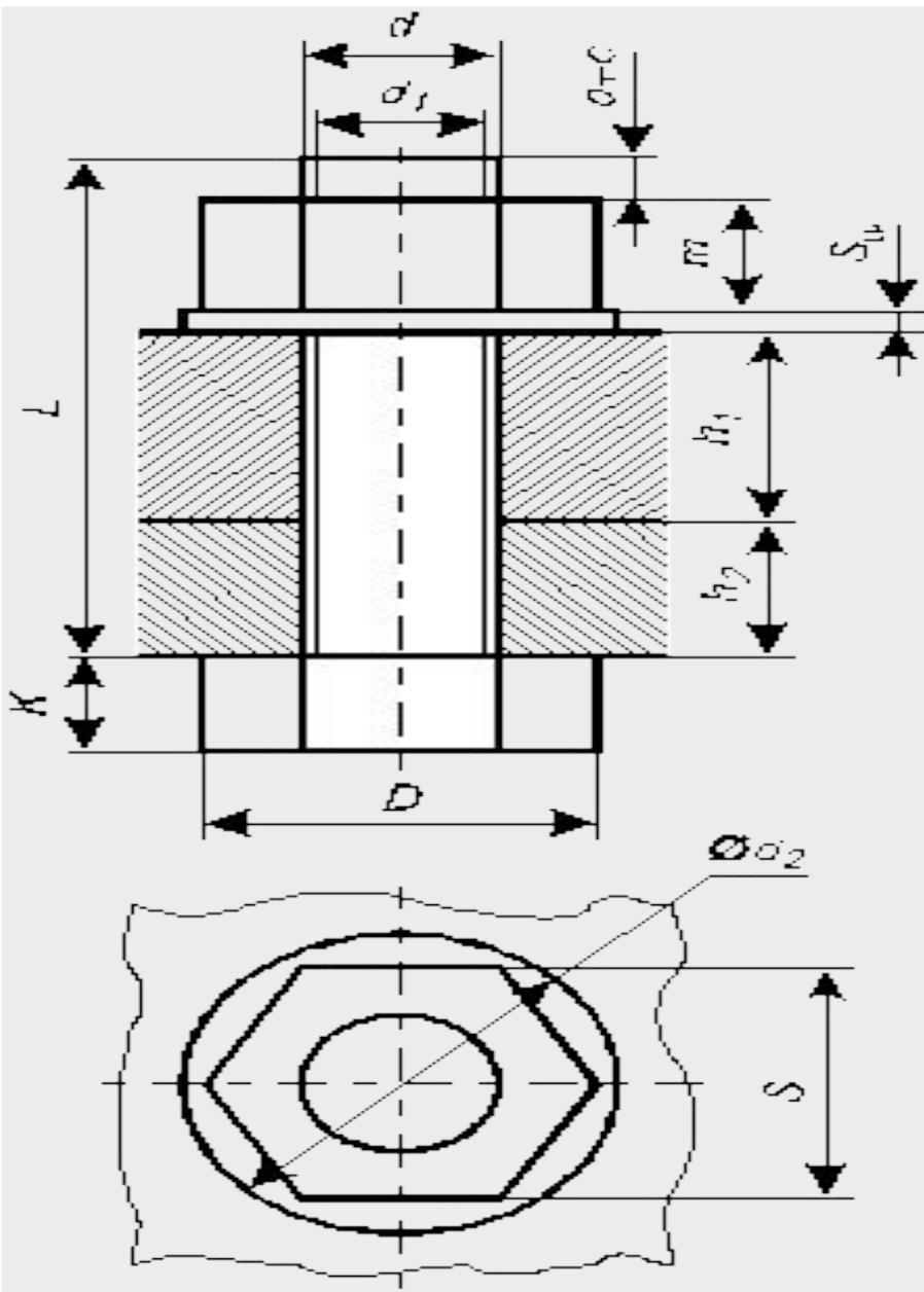
В болтовое соединение входит болт, гайка и шайба.
