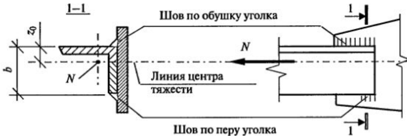
Прикрепление угловыми сварными швами уголка
